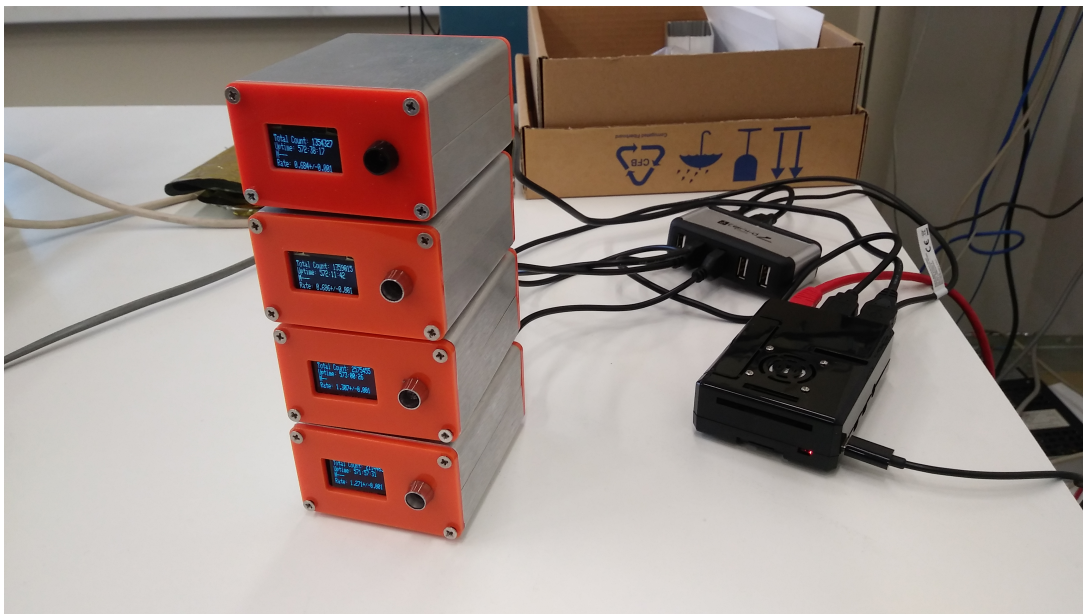
Rysunek 1: Układ pomiarowy składający się z czterech detektorów Cosmic Watch, Raspberry Pi i stacji dokującej USB używany do wykonania pomiarów
