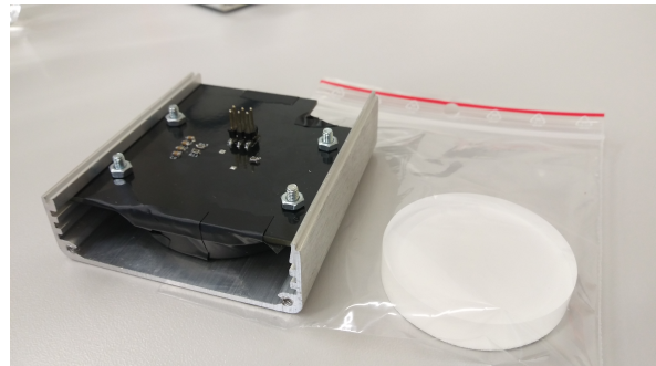
Rysunek 3: Płytki detektora oraz scyntylator (taki jak zamontowany na płytce); na płytce jest on umieszczony z tyłu i zabezpieczony taśmą w celu wyeliminowania zakłóceń
