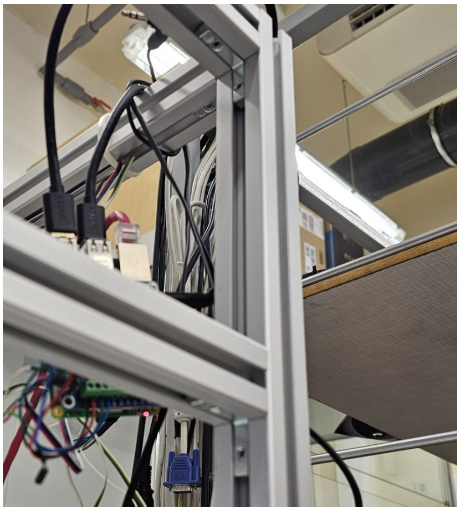
Rysunek 3: Zdjęcie prezentujące elementy mocujące poprzeczne elementy ramy, znajdujące się wewnątrz aluminiowych profili.
