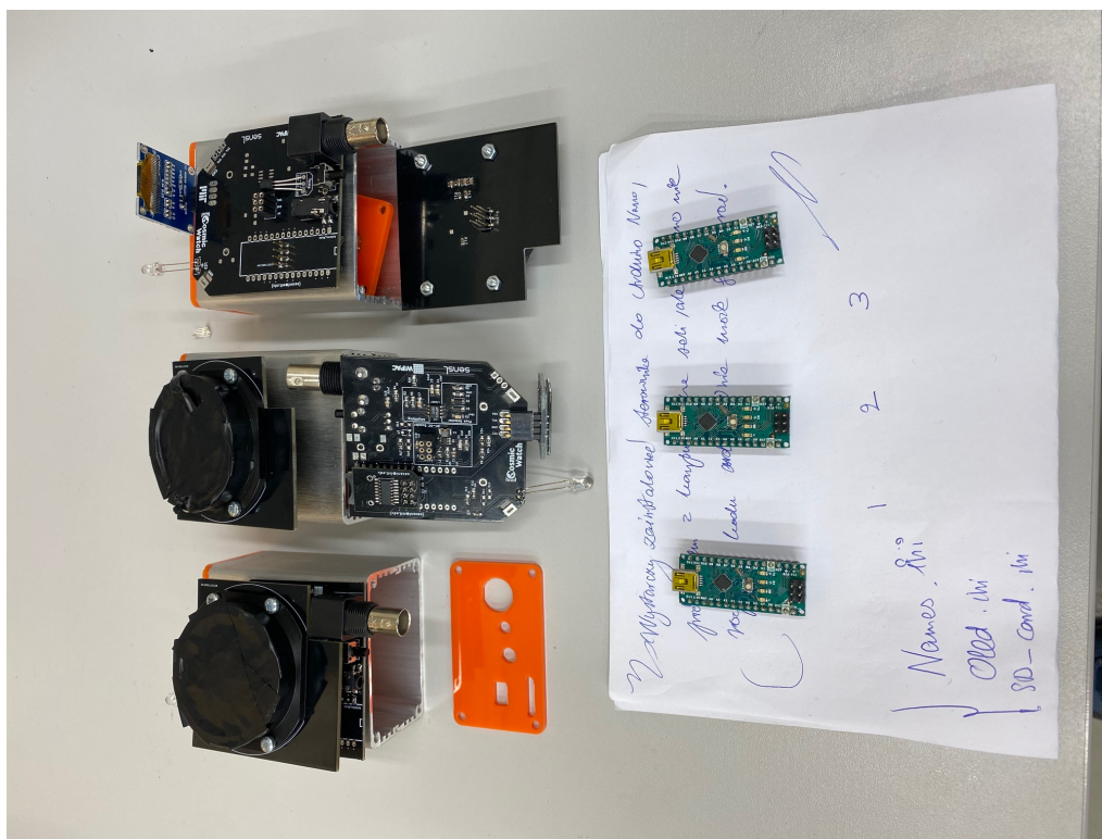
Rysunek 1: Zmontowane detektory Cosmic Watch oraz elementy przygotowane do instalacji (fot. własna).
